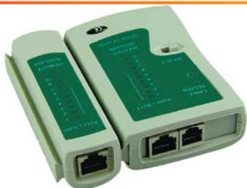
Тестер LT-007 для телефонного кабеля и кабелей на основе витых пар
